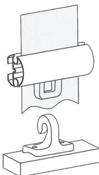
La fermeture du store se fait par le bas, avec un système d'ancrage bas, à positionner sur balustre ou au sol.
